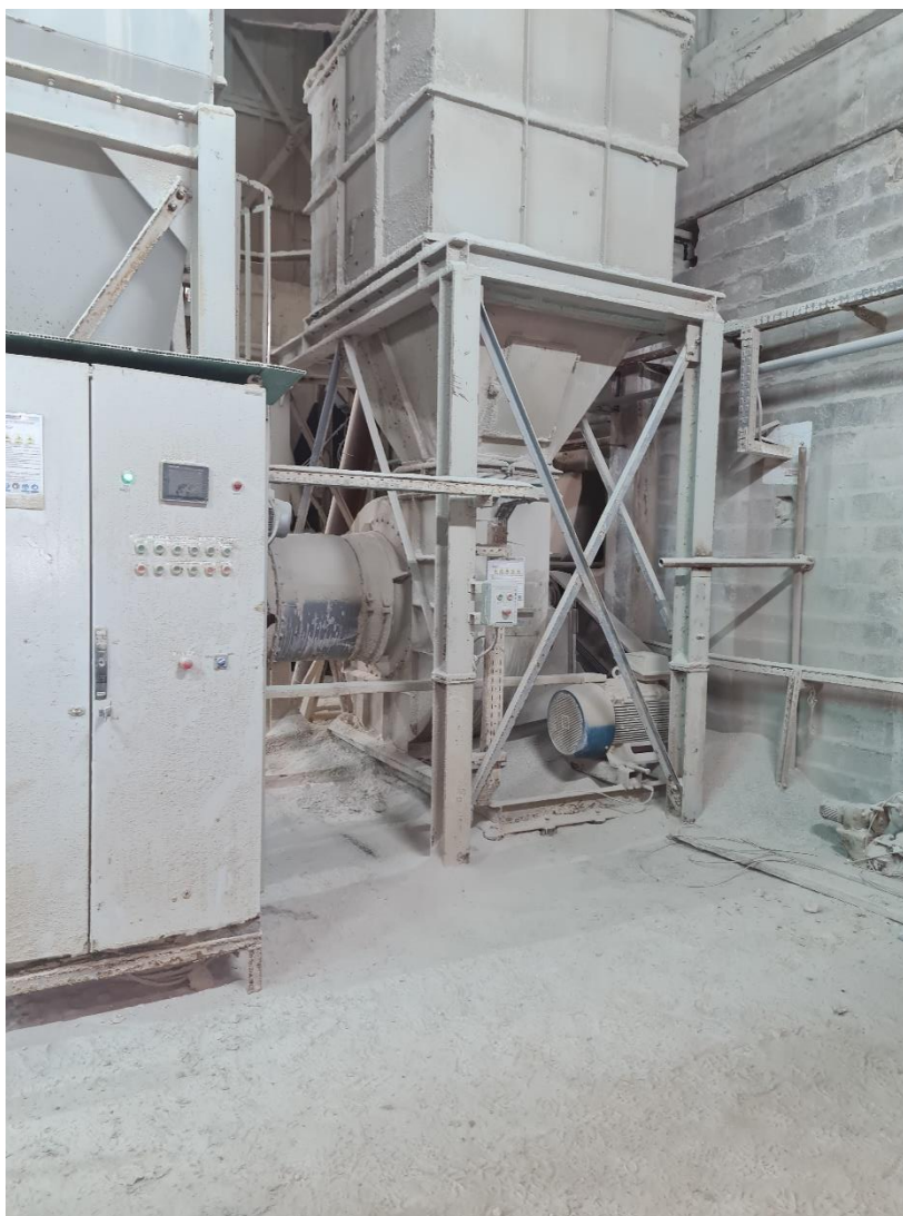
Слика 3. Систем за отпрашивање бр. 1 (C1)
